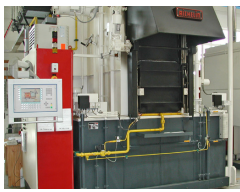
Bild 6: Mehrzweckkammerofen zur Wärmebehandlung von Wälzlager
